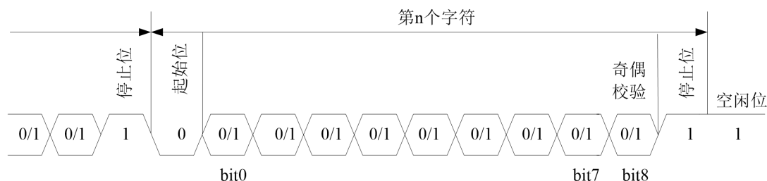
图 11.7 全双工异步通信数据结构图
