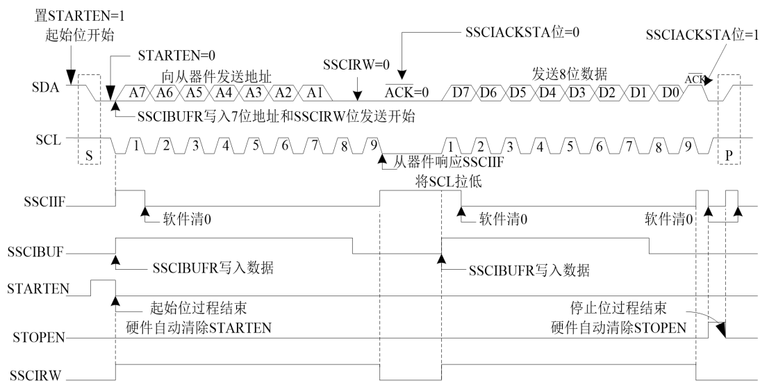
图 10.14 硬件 I2C 主模式发送数据时序图（7 位地址）
